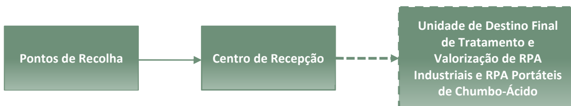
Figura 14– Sistema de gestão de RPA Industriais incorporáveis em EEE e RPA Portáteis de Chumbo-Ácido da AMB3E
